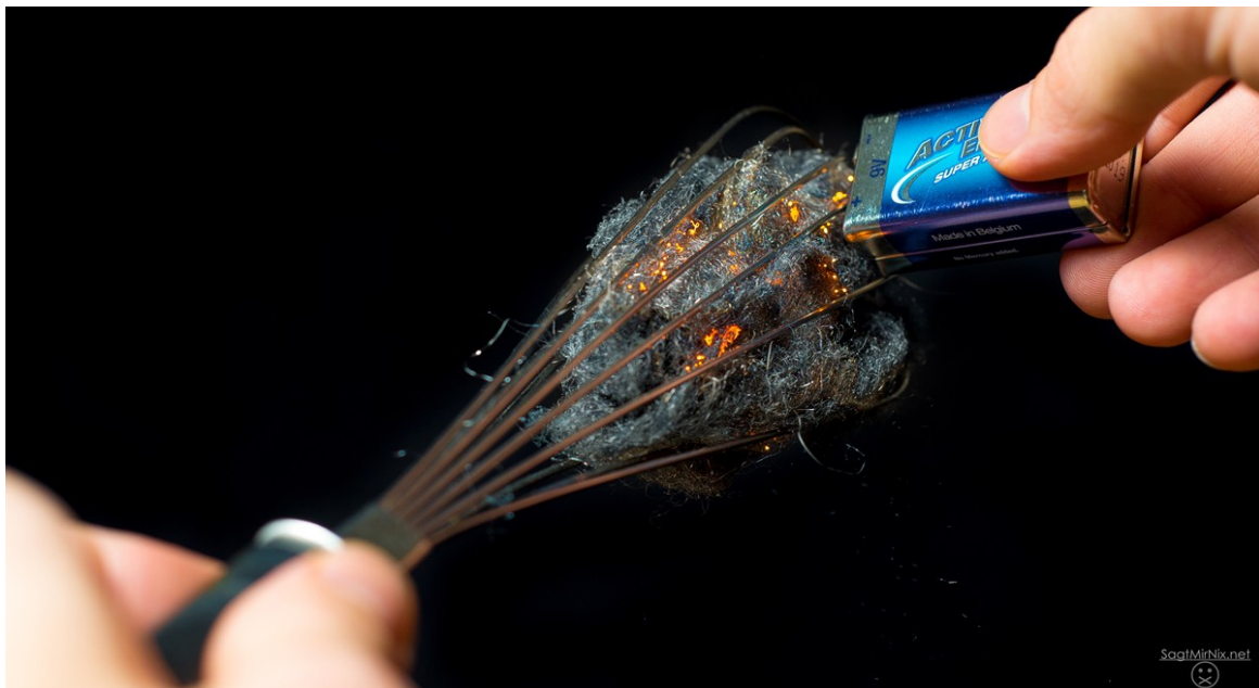
Stahlwolle mit Blockbatterie zum brennen bringen
